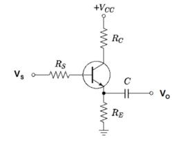
31 如圖所示之電晶體放大電路,基-射極接面於導通時所跨電壓視為定值 $(0.6\,\mathrm{V})$ ,求輸出電壓 $V_0$ 約為
